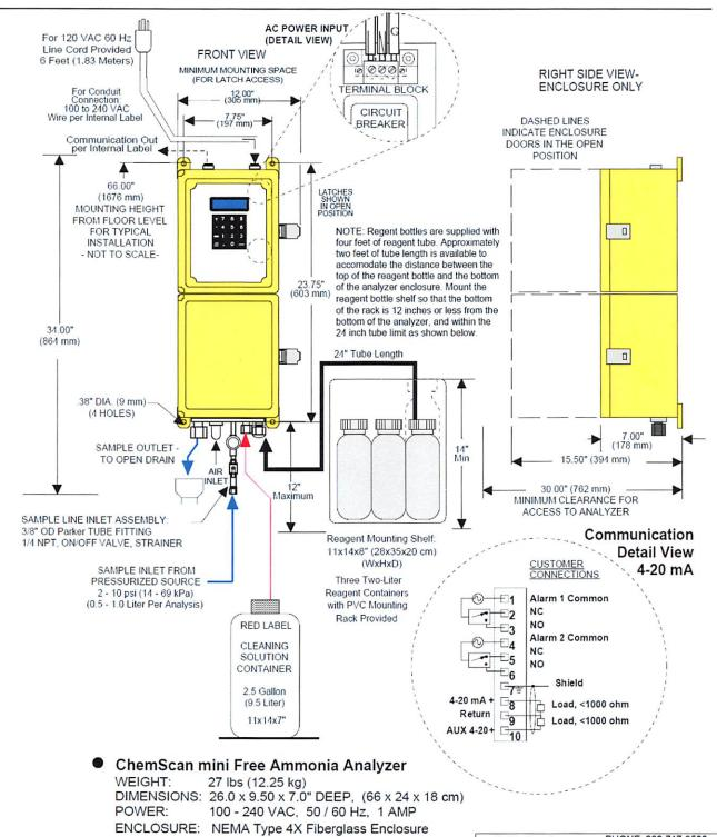
ChemScan mini Free Ammonia Analyzer - Installation Diagram
